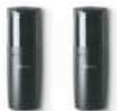
F210B fotokomórki (nadajnik+odbiornik) BLUEBUS, nastawne z kątem 210°, zasięg 15 m
